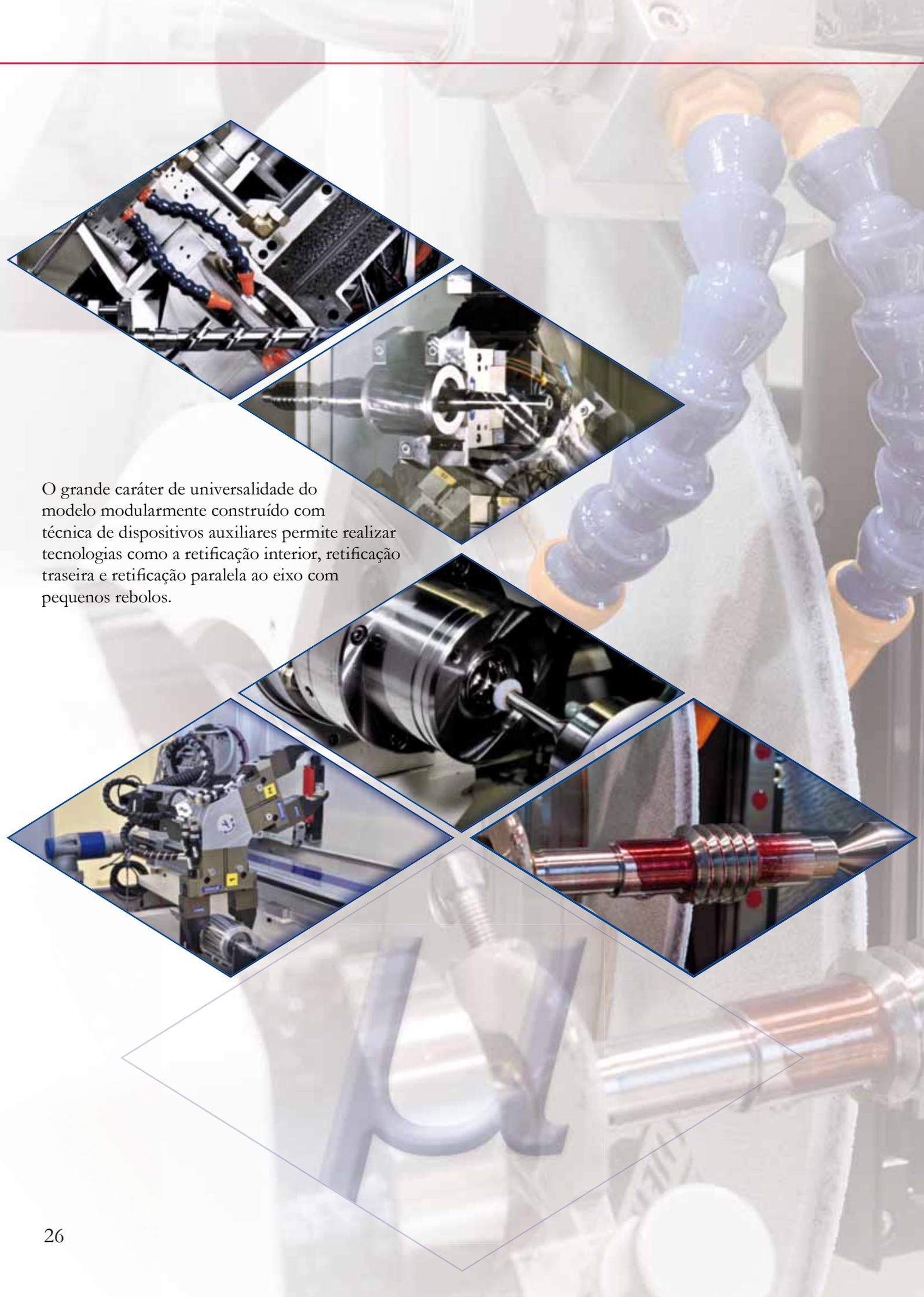
O grande caráter de universalidade do modelo modularmente construído com técnica de dispositivos auxiliares permite realizar tecnologias como a retificação interior, retificação traseira e retificação paralela ao eixo com pequenos rebolos.
