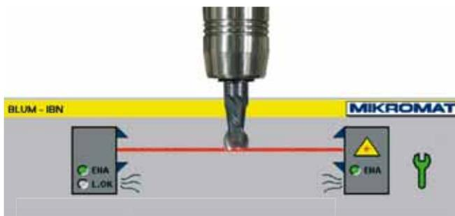
O sistema de medição por laser é um dispositivo de medição ótico para a análise automática da ferramenta no espaço de trabalho. Os dados de medição apurados constituem a base para a correção do desgaste da ferramenta e o critério para a mudança atempada da ferramenta.
