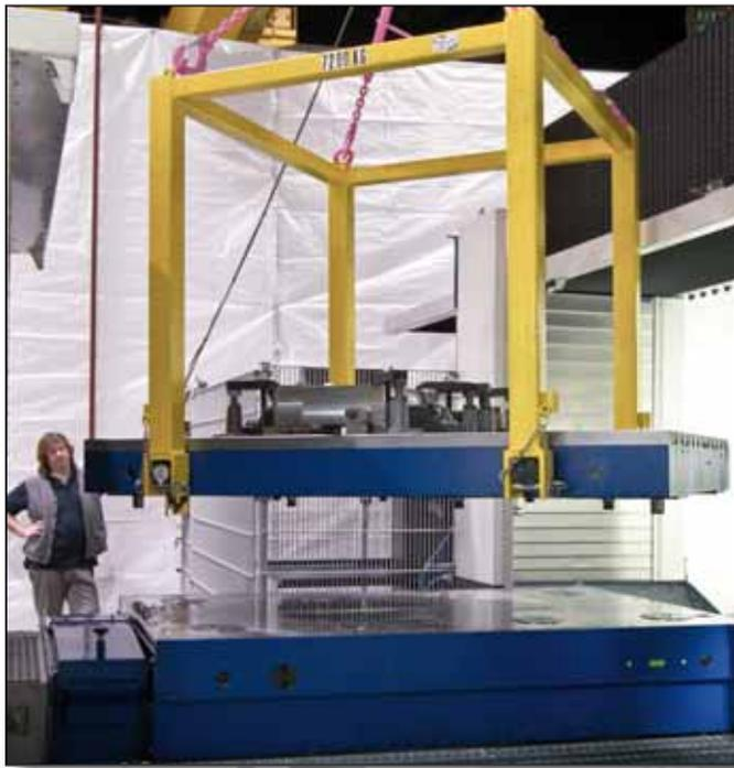
Mudança de paletas e sistema tensor de ponto zero para uma produção mais eficaz, equipando paralelamente em tempo útil
