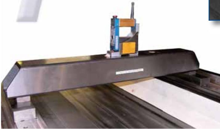
TA precisão dos eixos das máquinas combinada com a máxima precisão de fabrico relativamente à rectilindade e esquadria dos eixos da máquina, garantem a obtenção da máxima precisão volumétrica em todo o espaço de trabalho.
