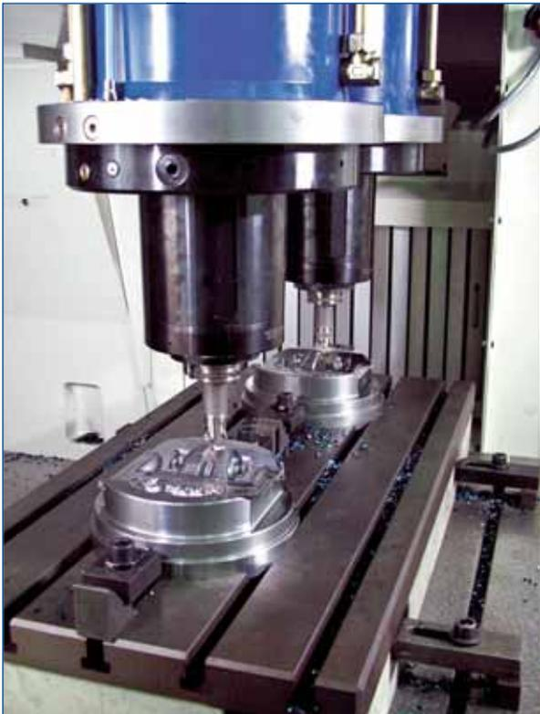
Os MIKROMAT 8V, 8V 2S e 8V HSC baseiam-se numa construção de máquinas dinâmica e estática otimizada no módulo de portal. O barramento da máquina perfeitamente dimensionado e o portal rígido asseguram, juntamente com as guias de recirculação de rolos de elevada precisão, uma precisão permanente na área da alta precisão.
