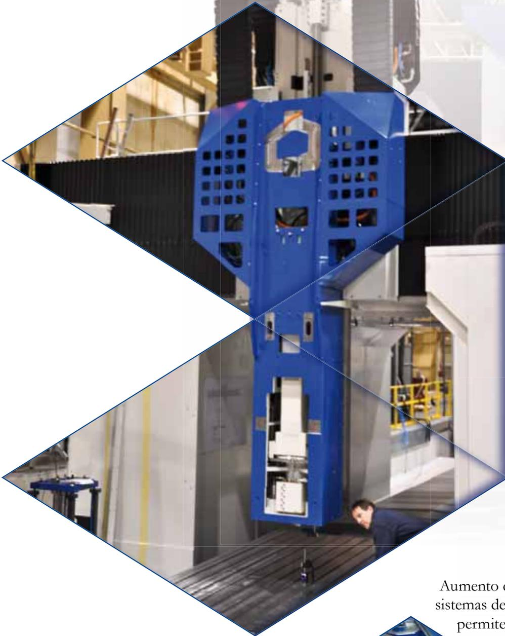
A forma de construção compacta da corredeira Z possibilita um percurso de deslocação de 2000 mm e pode ser, opcionalmente, equipada com um fuso de engrenagem ou de motor.
