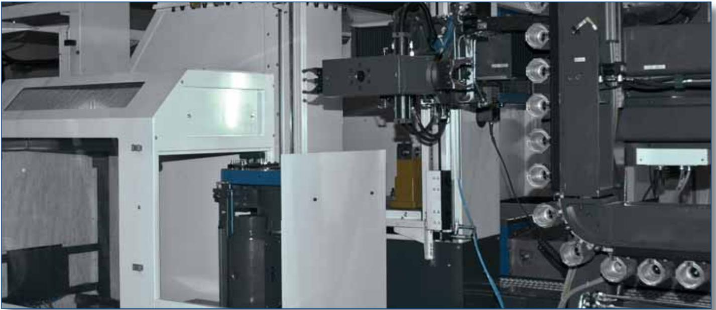
A utilização de um permutador automático de ferramenta (ATC) aumenta o grau de automatização do sistema. A mudança automática da ferramenta pode realizar-se no fuso principal vertical e também nas cabeças de processamento horizontais ou verticais. A quantidade dos locais da ferramenta do carregador é variável. A mudança da ferramenta realiza-se fora do espaço de trabalho. Pode-se, assim, manter o tamanho do espaço de trabalho completamente útil e evitar uma colisão.
