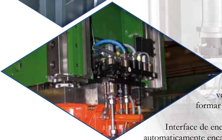
As cabeças de fresagem angulares universais com controlo NC permitem transformar a máquina num centro de processamento horizontal.
