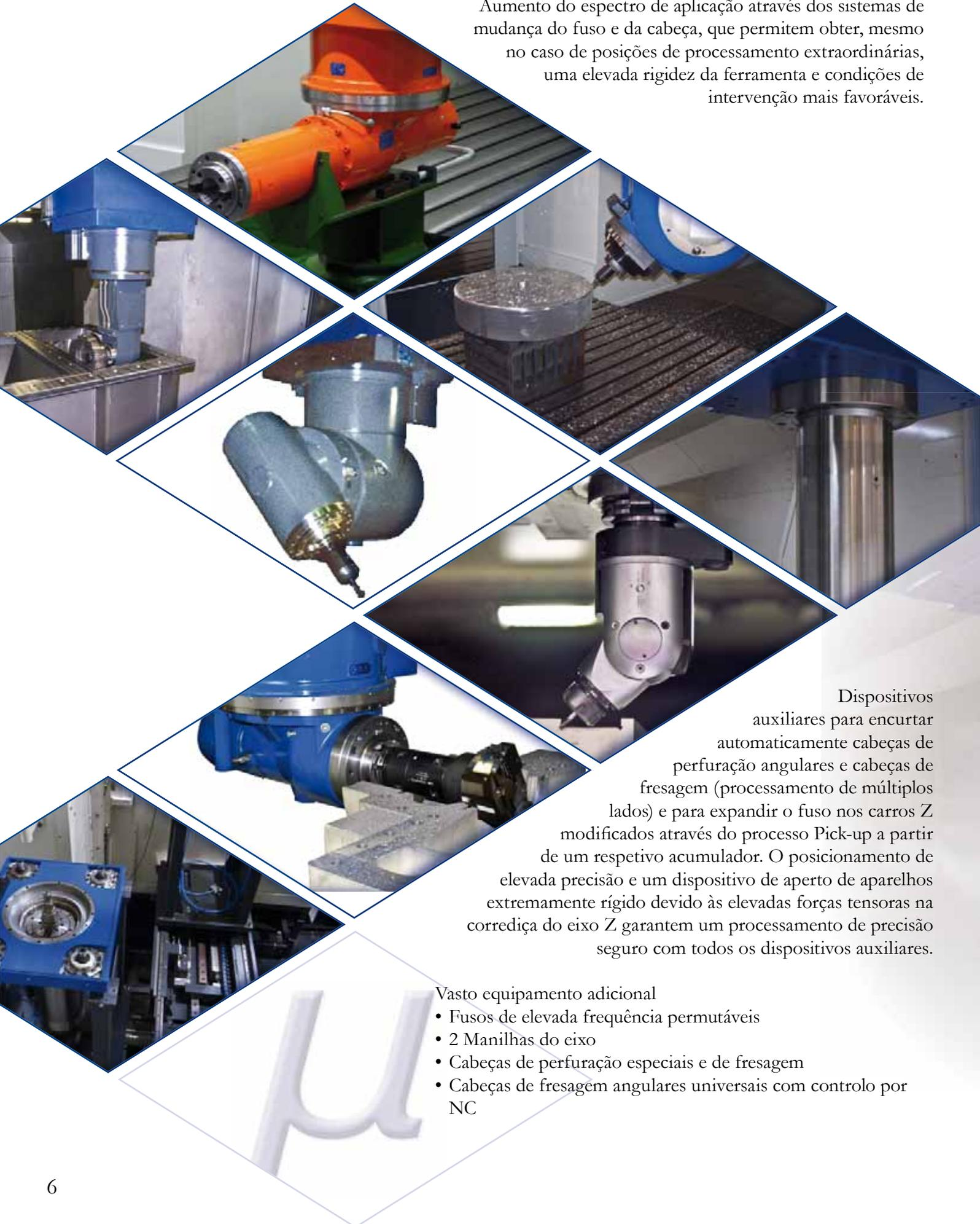
Dispositivos auxiliares para encurtar automaticamente cabeças de perfuração angulares e cabeças de fresagem (processamento de múltiplos lados) e para expandir o fuso nos carros Z modificados através do processo Pick-up a partir de um respetivo acumulador. O posicionamento de elevada precisão e um dispositivo de aperto de aparelhos extremamente rígido devido às elevadas forças tensoras na correção do eixo Z garantem um processamento de precisão seguro com todos os dispositivos auxiliares.
