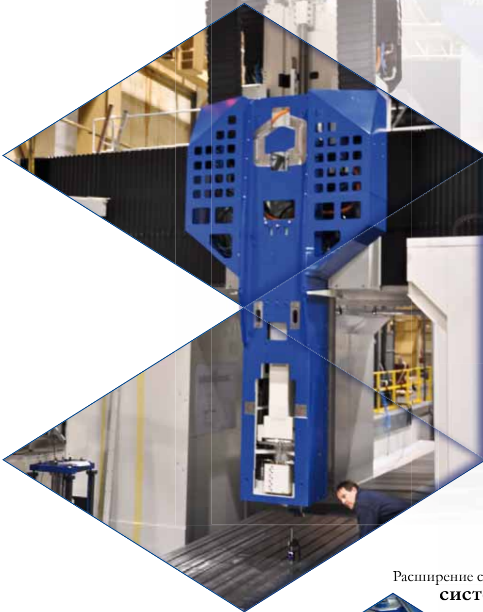
Шпиндельная бабка (ось Z) с перемещением на 2000 мм
